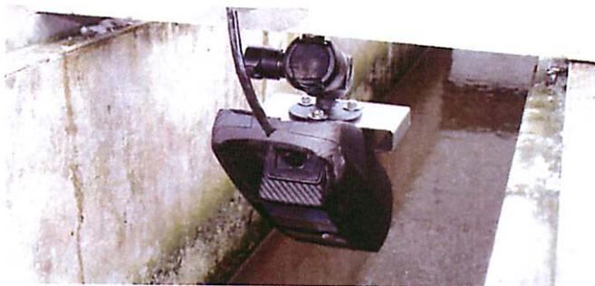
Abb. 3: Radar/Ultraschallmessung
